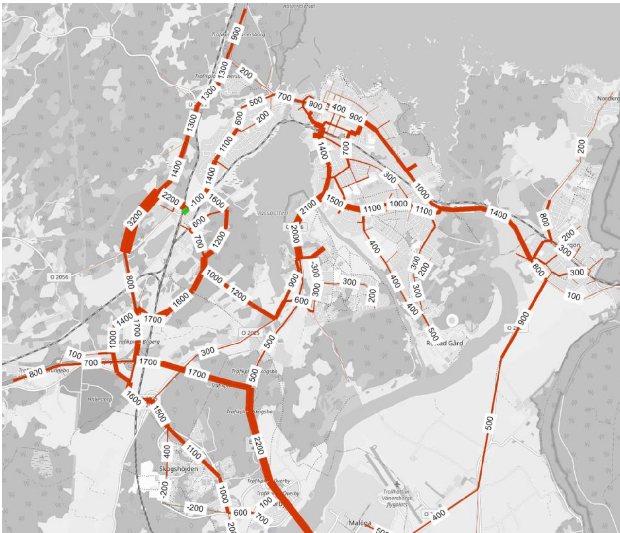
Figur 7 Differensbild som visar skillnad i trafikmängder för Bostadsscenario 2040 med vägutbyggnad enligt alternativ V2 jämfört med nuläget. Röd färg visar trafikökning, grön färg visar trafikminskning.
