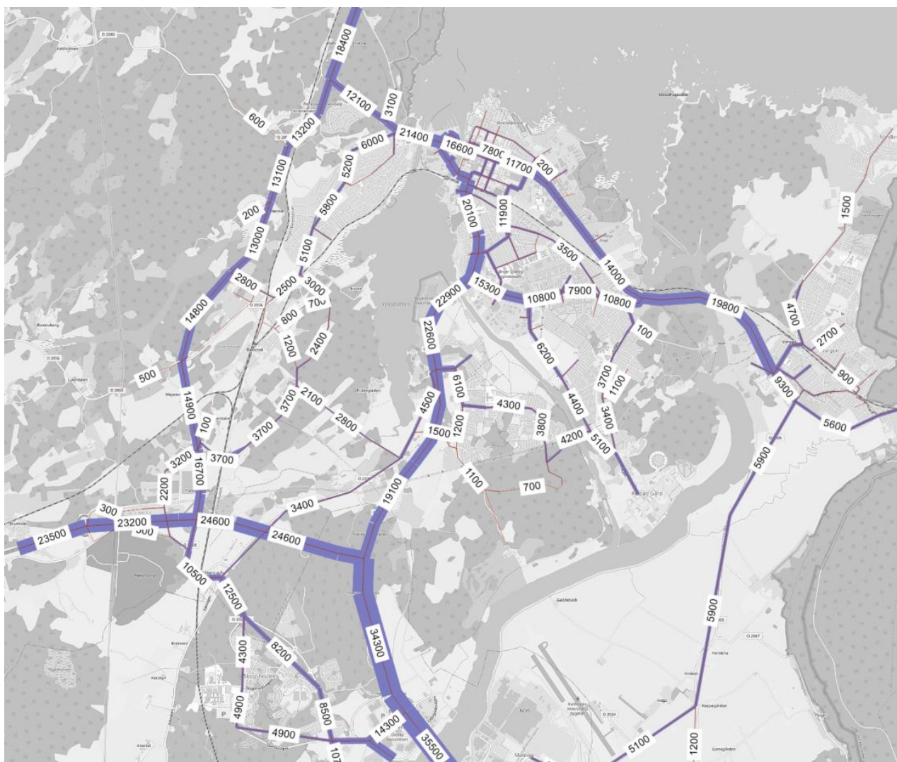
Figur 11 Modellberäknad trafik för scenario Full bostadsutbyggnad med vägutbyggnadsalternativ V4, fordon/vardagsdygn
