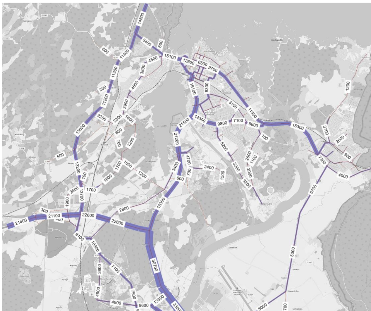
Figur 6 Modellberäknad trafik för scenario bostadsutbyggnad 2040 med vägutbyggnadsalternativ V2, fordon/vardagsdygn
