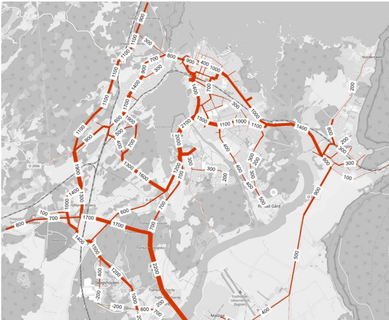
Figur 5 Differensbild som visar skillnad i trafikmängder för Bostadsscenario 2040 med vägutbyggnad enligt alternativ V1 jämfört med nuläget. Röd färg visar trafikökning, grön färg visar trafikminskning.
