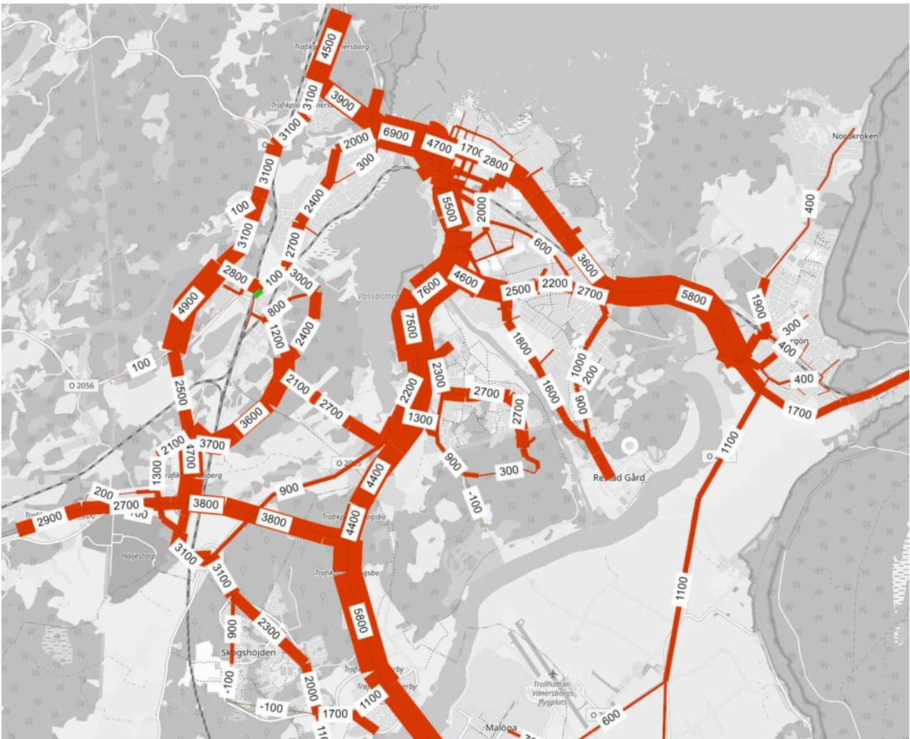
Figur 10 Differensbild som visar skillnad i trafikmängder för Bostadsscenario Full utbyggnad med vägutbyggnad enligt alternativ V3 jämfört med nuläget. Röd färg visar trafikökning, grön färg visar trafikminskning.
